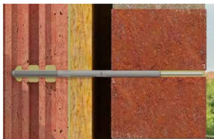
VBS 8 Verblendsanieranker Injektion
