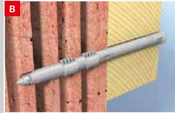
**B In Lochbaustoffen** erzeugen die Lamellen Spreizkräfte am Steg und eine Verzahnung im Hohlraum.
