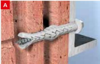
**A In Lochbaustoffen** wird durch die zwei Spreizzonen eine untergrundschonende Krafteinleitung gewährleistet. Die porösen Steinstege werden durch die Spreizzonen nicht zerstört und können dadurch zur Kraftweiterleitung herangezogen werden.
