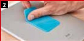
2 Eine der beiden Schutzfolien abziehen und das VAKUUM PAD fest auf die Rückseite des Tablets drücken.
