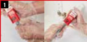
1 Handschuhe anziehen und wiederverschließbaren Deckel öffnen. Mischdüse aufdrehen.
