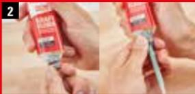
2 Wiederverschließbaren Deckel öffnen. Mischdüse aufdrehen.
