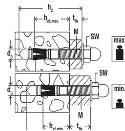
Bolzenanker FAZ II (Standard-Version) / Bolzenanker FAZ II H (Version mit Hutmutter)
