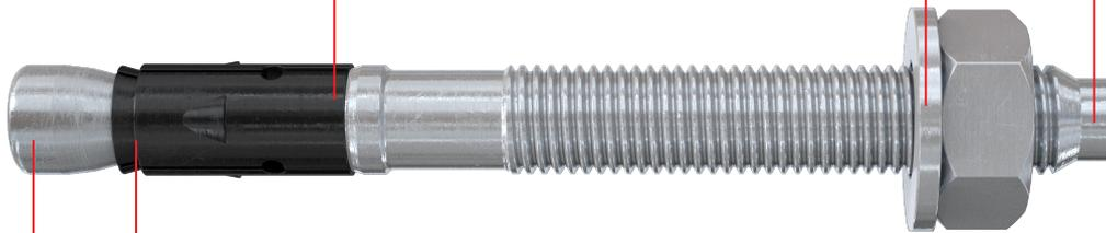
Das Zusammenwirken von Konus und Spreizclip erhöht die Zugtragfähigkeit entscheidend und ermöglicht **minimale Rand- und Achsabstände**.
