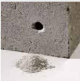
Beim Bohren in Beton entsteht staubfeines, aber noch rieselfähiges hellgraues bis weißes Bohrmehl. Langsamer Bohrfortschritt.
