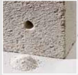
Porenbeton-Bohrmehl ist weiß, grobkörnig und leicht schmierig. Weich und leicht zu bohren.
