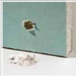
Gipsfaserplatten sind weich, liefern weißes faseriges und Gipskarton weißes feines Bohrmehl, das am Bohrer kleben bleibt.
