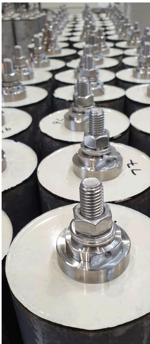
Verankerungsmittel müssen in aufwendigen Versuchsreihen geprüft werden. Hier ist zu sehen, wie Prüfzylinder aus einer beschichteten Betonfläche entnommen wurden.
