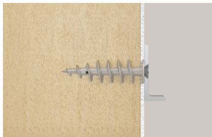
Řez upevněním s FID II Plus v dřevovláknité desce
