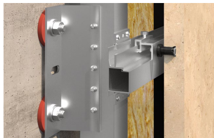
Řez upevněním SystemOne s obkladem z přírodního kamene
