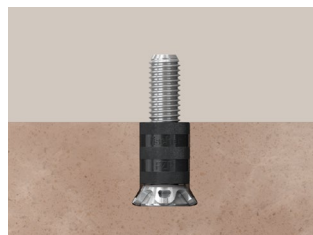
Názorný řez kotevním bodem při povrchové montáži
