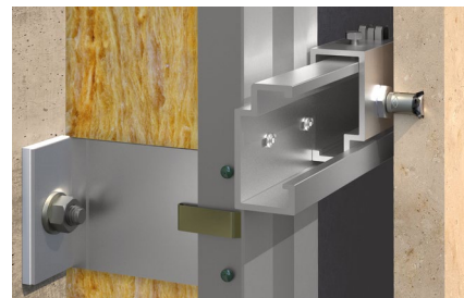
Řez aplikací s distanční montáží
