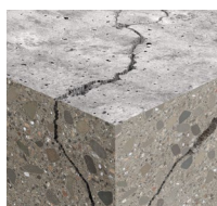
Taženou zónu betonu
